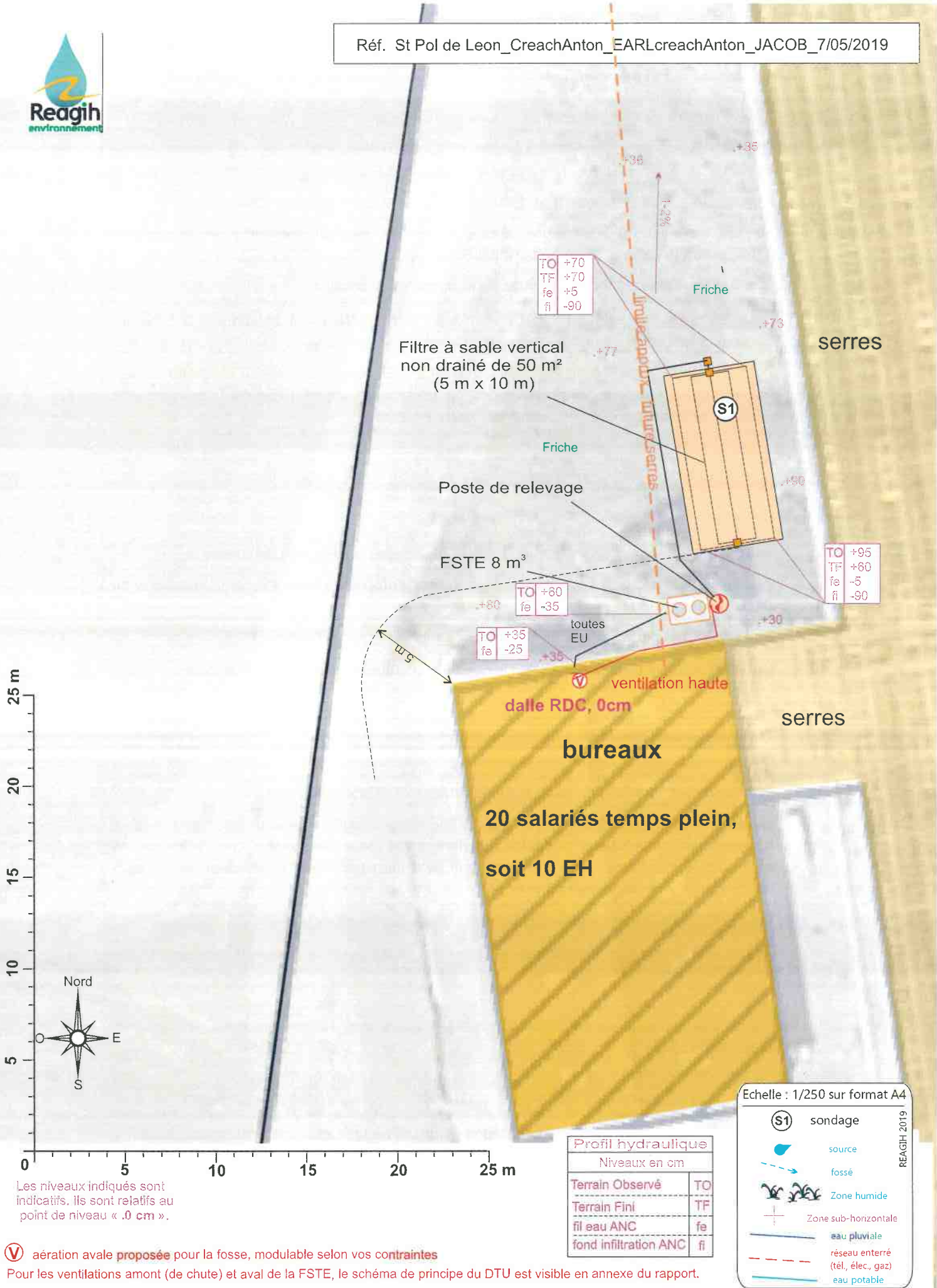
Figure 3 : Schéma d'implantation du dispositif d'assainissement et profil hydraulique à plat.
